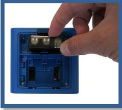
Une fois que trois piles AA ont été placées dans le support, il doit être réinséré dans le lecteur. Le support ne s'adapte que dans un sens, les coins arrondis pointant vers l'arrière de l'appareil. Une protection anti-torsion protégera une mauvaise insertion latérale. Si le support semble se coincer dans son logement, veuillez tourner l'adaptateur et réessayer l'insertion. Un « clic » se produit lorsque l'adaptateur a été inséré complètement et correctement.
