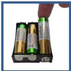
Si aucune pile n'est insérée dans le support ou si les piles doivent être changées, de nouvelles piles doivent être placées dans le support. Suivez les repères sur le support pour assurer la polarité correcte ('+'- inscrivez-vous, voir Fig.). Ajoutez les piles une par une.
